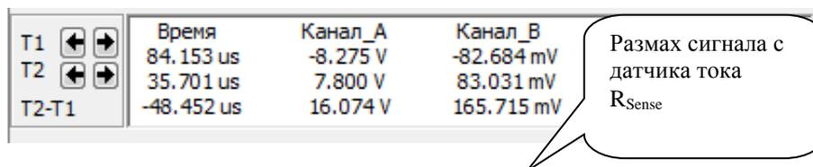
С помощью канала В измеряем напряжение датчика тока, следовательно, значение  $V_B$  соответствует току. Размах тока в два раза превышает амплитуду, следовательно, при размахе напряжения в 165.715 мВ (мВ) амплитуда составит 82,7 мВ (мВ). Чтобы определить ток  $I$ , нужно разделить напряжение датчика тока на его сопротивление:
