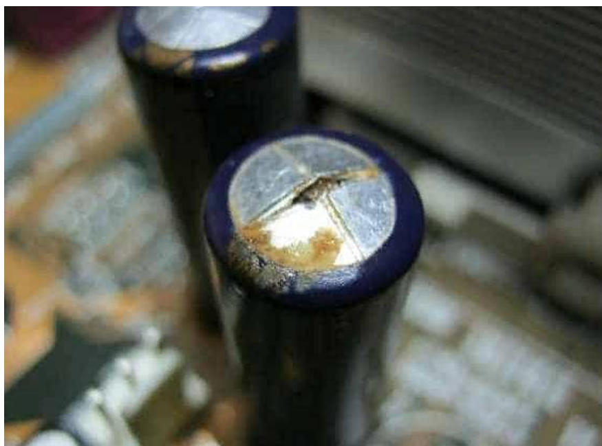
Рисунок 10 - Конденсаторы с нарушенной геометрией корпуса
