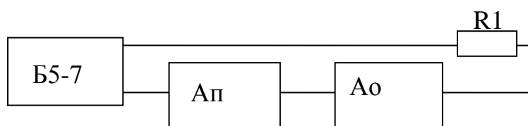
Рисунок 1 – Схема соединения приборов для проверки технического амперметра на постоянном токе
