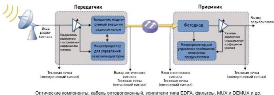
Рис.2. Основные компоненты радиопотонных систем
