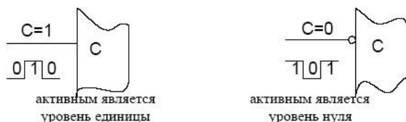
Рис.1.Статическое (потенциальное) управление
