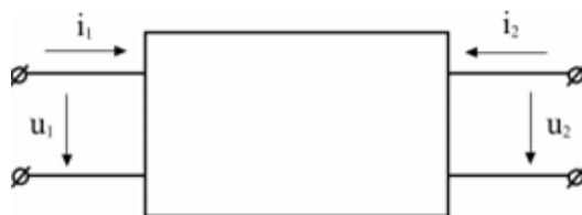
Рис.4. Транзистор, как активный четырехполюсник
