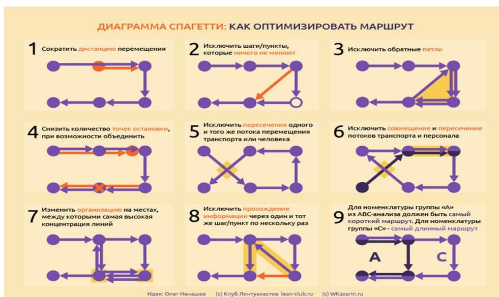
Рисунок 1 – Пути оптимизации маршрута перемещения работников, продукции, транспорта, инструментов или сырья
