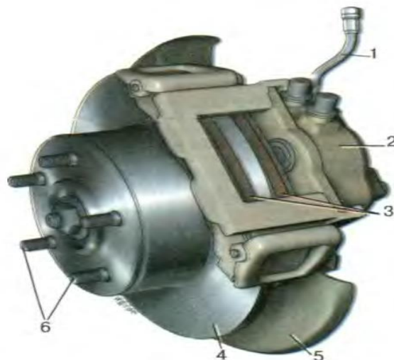
Рисунок 1 – Дисковый тормоз переднего колеса легкового автомобиля
