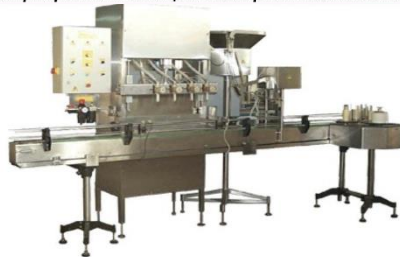
Автоматизированная линия с пневмоприводом
