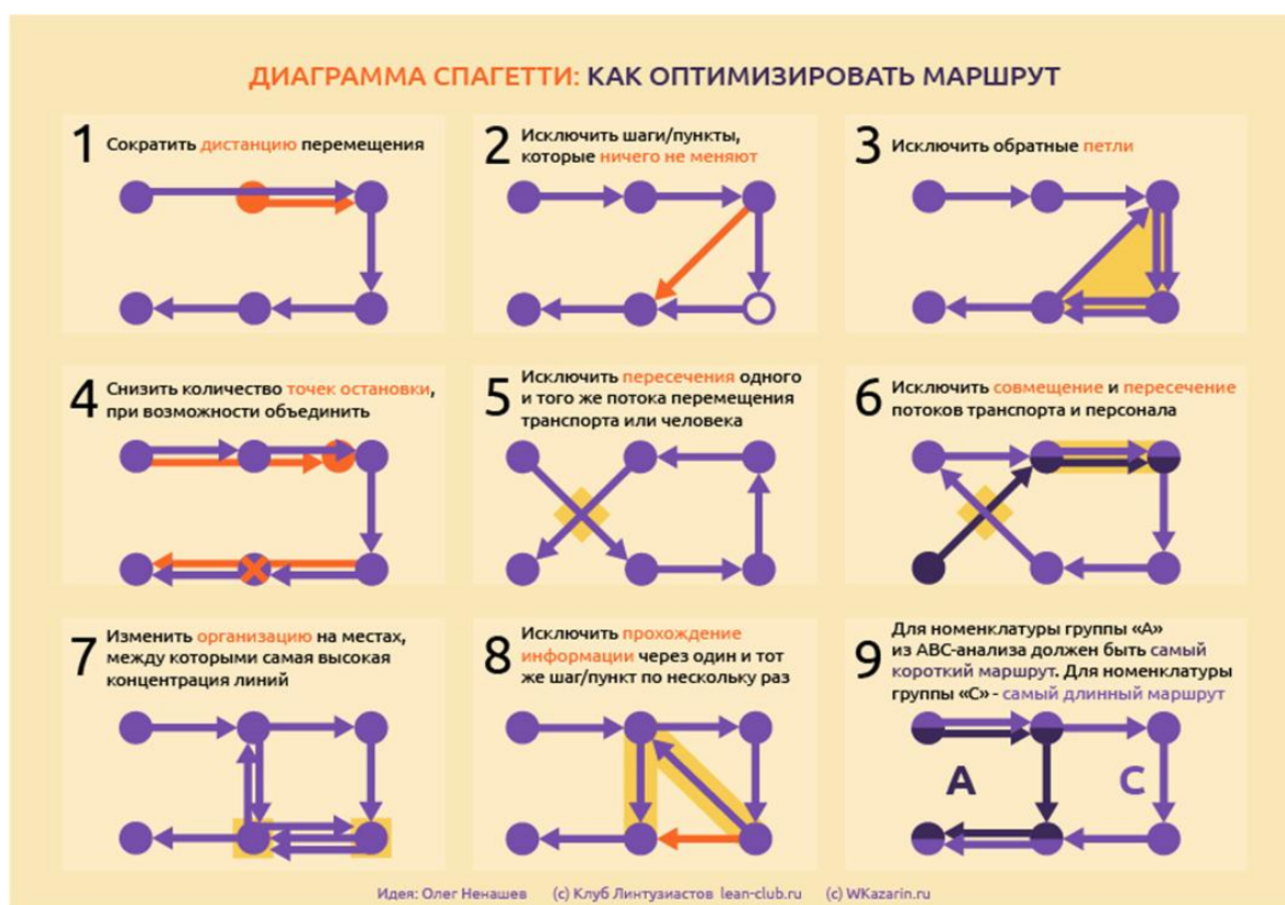
Рисунок 1 – Пути оптимизации маршрута перемещения работников, продукции, транспорта, инструментов или сырья
