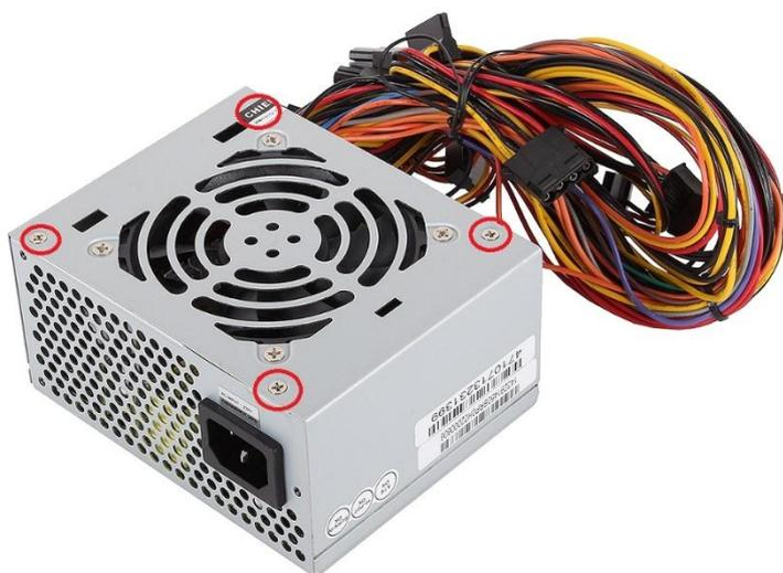
3.2. Очистите внутренне пространство блока питания от пыли с помощью кисти до такой степени, чтобы маркировка электронных компонентов была читаема.
